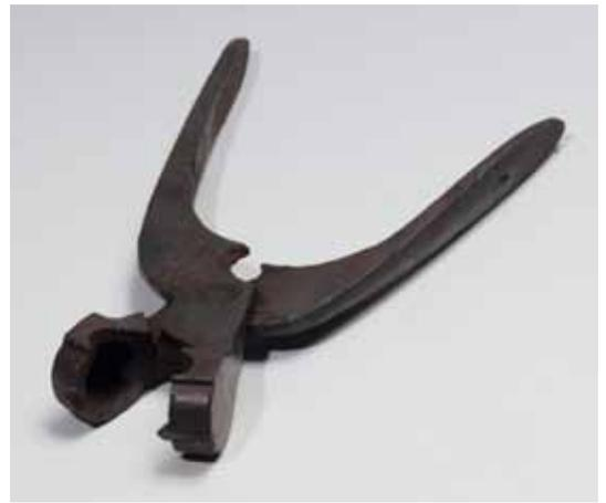
**Kugelzange für Rundkugel** ~ Eisen ~ zweite Hälfte 18. Jahrhundert ~ 14,4 × 4 cm ~ {StM 93/167/W 8}
